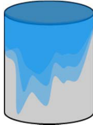
Abb. 61: Annahme der Ausbreitung der Lösungsfront in A1-Proben aus dem TZF 90 (3-1-8 und 5-1-8 Phase im Bindemittelphasenbestand) bis durch die Kristallisation von 3-1-8 Phase aus 5-1-8 Phase der lösungszugänglichen Porenraums wirksam verschlossen ist
