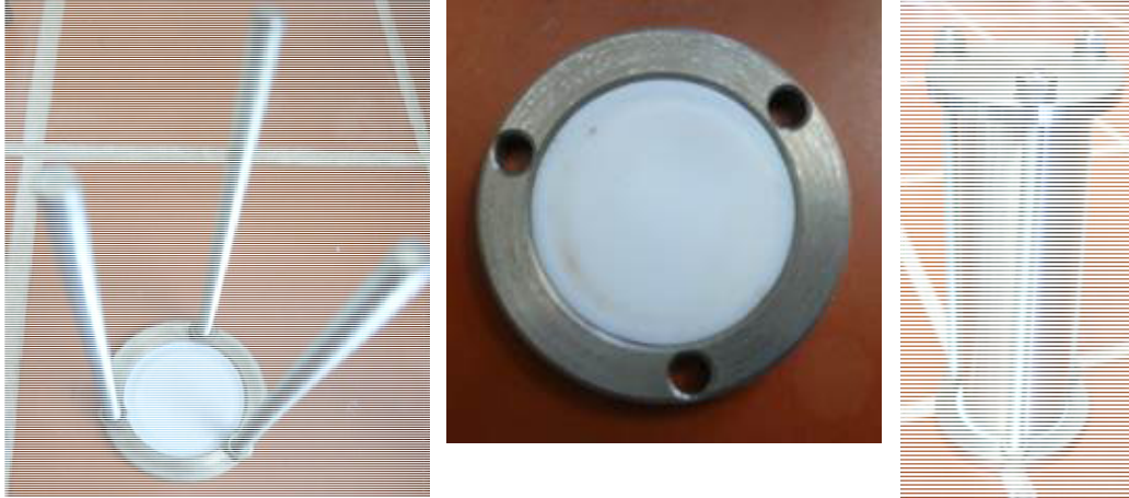
Abb. 3: Gasdichte Probezelle (IfAC-Zelle) und deren Bestandteile (von links nach rechts: Verschraubungsvorrichtung mit Zellboden und Teflondichtungsscheibe; Deckel mit Teflondichtungsscheibe; komplett verschraubte Edelstahlprobezelle mit Edelstahlrohr und innerer PE-Hülse; \varnothing -innen = 30 mm, \varnothing -außen = 34 mm, h = 110 mm und einem Fassungsvermögen von 58 mL)
