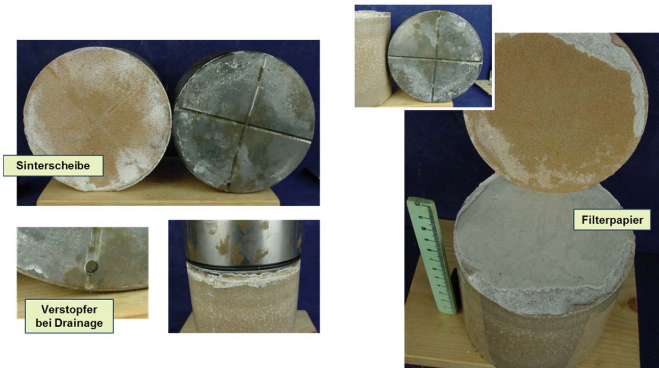
Abb. 11: Probenzustand nach Auspressen einer A1-Probe aus den IfG-Probemesszelle (s. Abb. 4; links: Zustand der Sinterscheiben und Kontakt zum Stempel; rechts: Filterpapier und Sinterscheiben)
